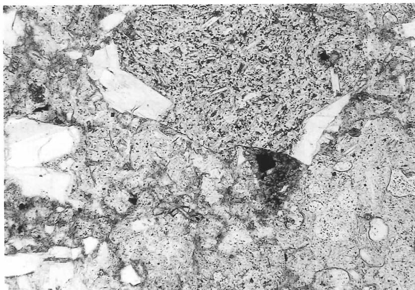
図2 中部の水冷破碎溶岩(試料1)のマトリックス部分に見られる角張った外来岩片(上)と不規則な形をした溶岩の破片(右下)。写真の横幅は約3mm。
