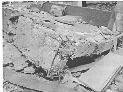
写真 3.19.2 発泡スチロール粒が混入されたコンクリート
