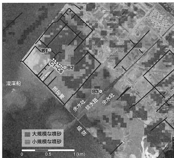
図8 埋立状況、排砂管の配置と被害分布
